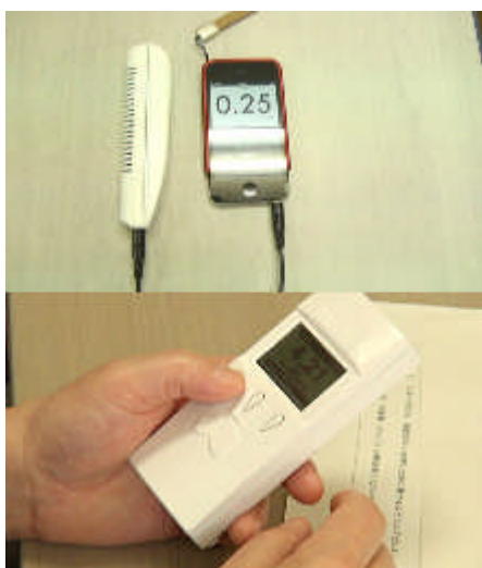
完成した「ガイガー-FUKUSHIMA」。左がiPhone接続タイプ、右がLCDタイプ
